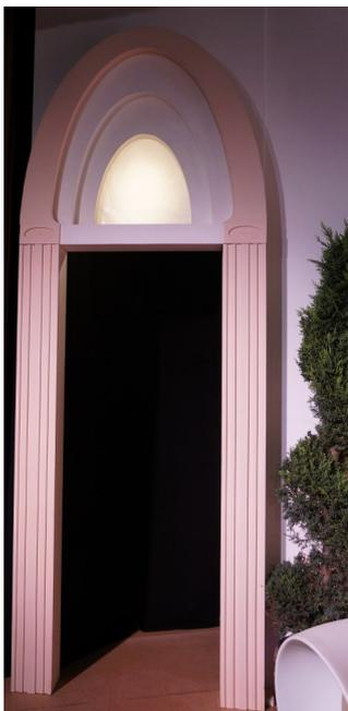
En avant scène, il y a deux portes de 1m20 de large avec 2 colonnes cannelées de 20x20 cm et de 2m20 de haut surmontées par un fronton fenêtré de 120x110 cm, composé par des demi-ovales.
