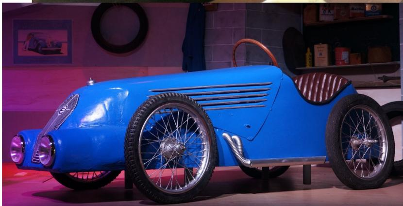
très souple. L'avant est en polystyrène façonné avec un fer spécial. Deux phares y sont intégrés avec une batterie 12V et activés par le chauffeur. Le siège est réalisé en simlicuir et le volant est un prêt. La finition est faite avec un mastic pour carrosserie et la peinture est un réel bleu bugatti.
