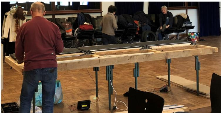
Le convoyeur à bagages est constitué de 3 tapis de courses, démontés pour s'adapter à notre besoin.
