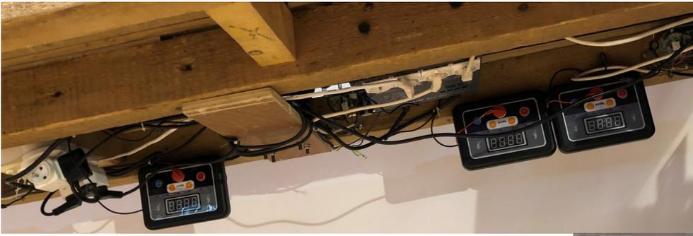
**Les commandes des tapis de course** sont réutilisées et déclenchées par le système de lumière en DMX.
